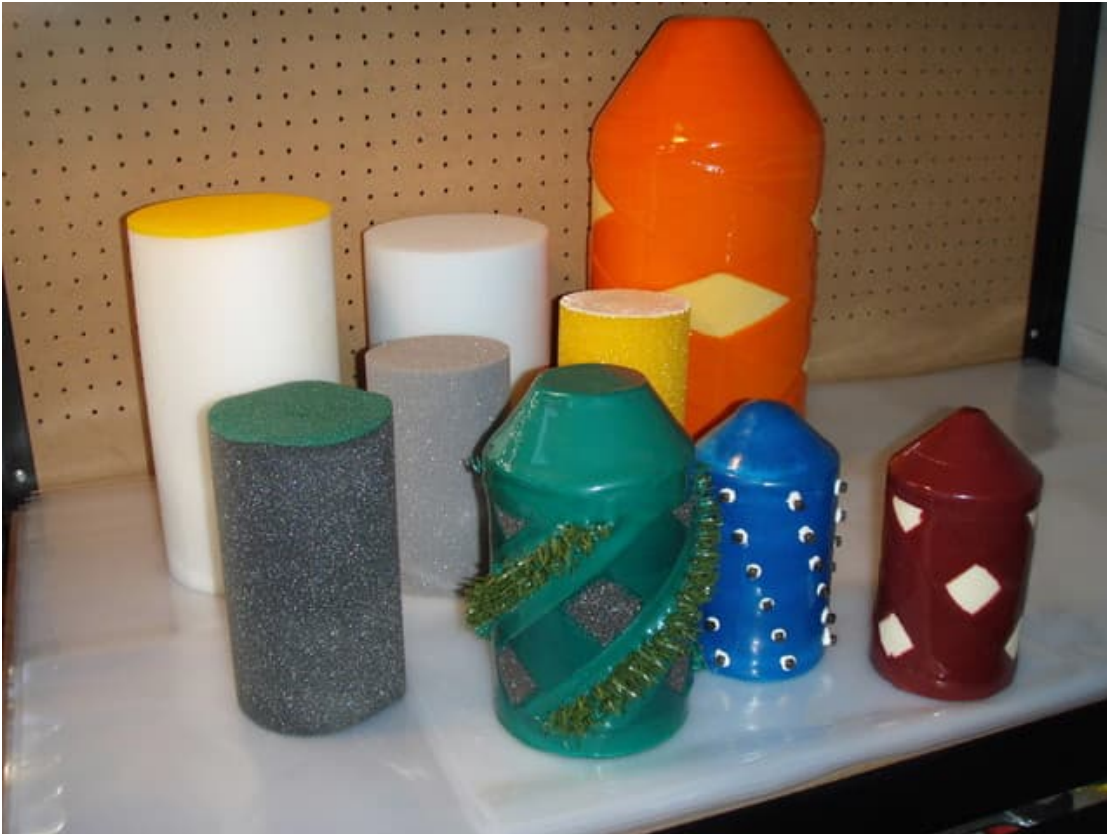
Kuva 16. Elementtipuhdistus (possutus) on tehokas vesijohtojen puhdistusmenetelmä. Kuvassa erilaisia puhdistuselementtejä.
