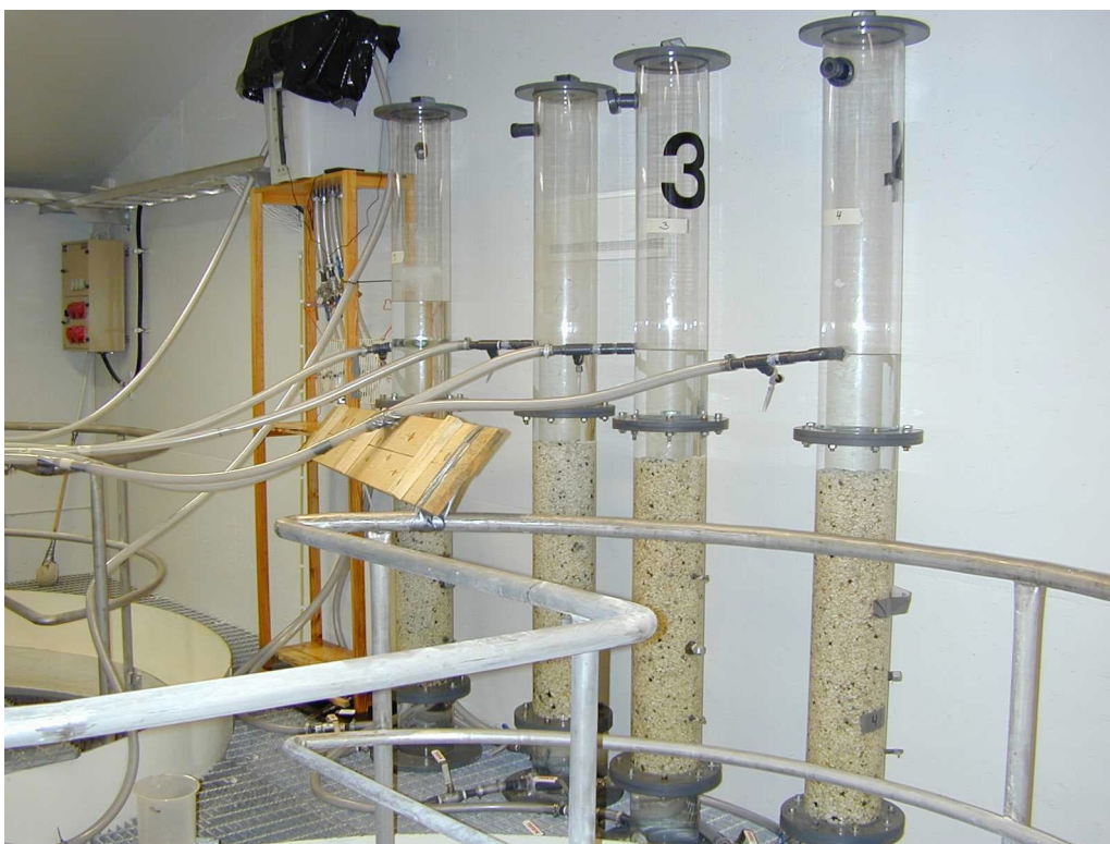
Kuva 10. Teknillisen korkeakoulun (nyk. Aalto yliopisto) vesihuoltolaboratorion tutkimuksissaan käyttämä pilot-laitteisto. Ylävesisäiliö on peitetty mustalla muovilla roskien ja pölyn pääsyn estämiseksi pilot-laitteistoon.
